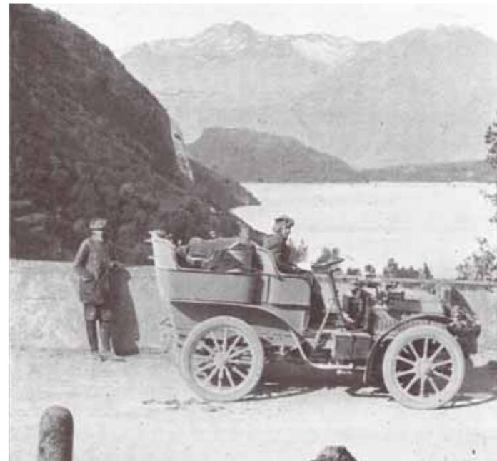
„Bei Lecco am Comer See im Opel Darracq 1903: Im Januar bestellt – am 20. Mai abgeholt. Neuer Wagen aus Rüsselsheim 24-28 PS Opel Darracqwagen, Karosserie ein Tonneau mit grauer Lackierung und dunkelblauer Lederpolsterung, ein Vierzylinder, mit elektrischer Zündung, Kraftfahrübertragung mittels Cardan.“
